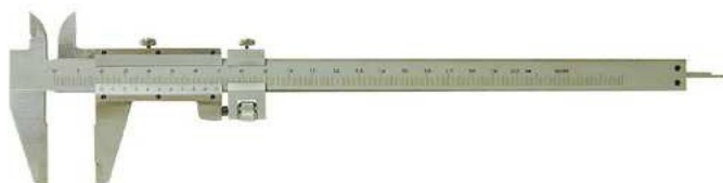
Pied à coulisse à bec double et jauge de profondeur Précision: 1/50e (résolution 0.02 mm) - Longueur : 150 mm ou 200 mm - Standard ou numérique
